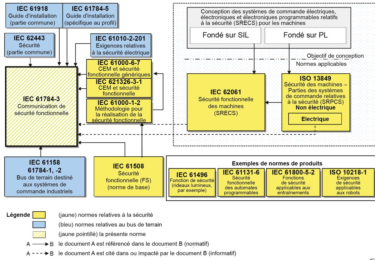
NOTE Les paragraphes 6.7.6.4 (haute complexité) et 6.7.8.1.6 (faible complexité) de l'IEC 62061 spécifient la relation entre PL (catégorie) et SIL. L'IEC 62061 spécifie la relation entre PL (Catégorie) et SIL.
