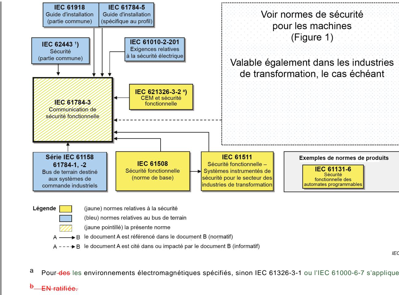
**Figure 2 – Relations entre l'IEC 61784-3 et d'autres normes (transformation)**
